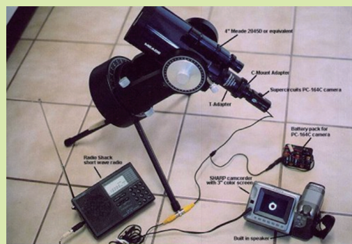
圖9. Richard Nugent 的可攜式掩星觀測裝備，包括望遠鏡、錄影機、收音機（對時），以及電池組。國內對時可以使用手機報時，裝備更精簡。 http://www.lunar-occultations.com/iota/video/rnvideosetup.htm
