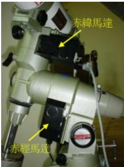
Fig.5 SkySensor 赤經與赤緯馬達接法示範
