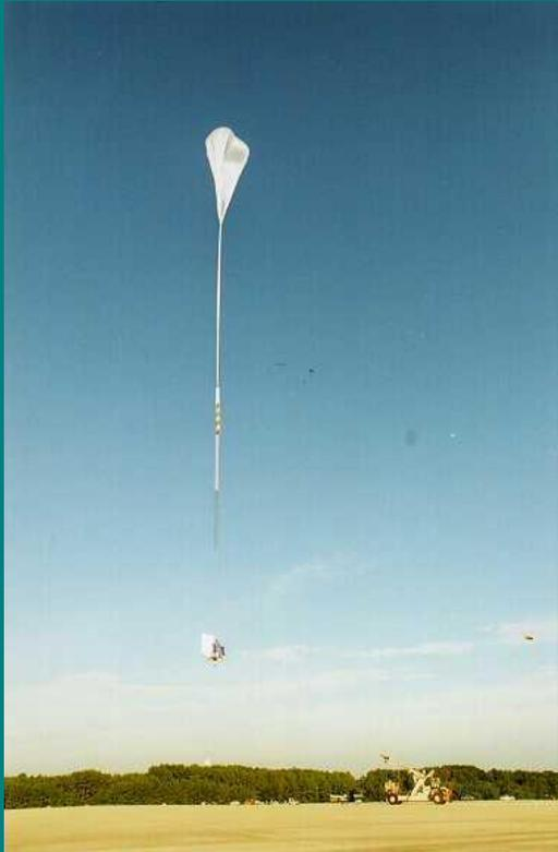
高空氣球實驗 Balloon Observations of Millimetric Extragalactic Radiation and Geophysics (**BOOMERANG**), 在南極上空測量10天，得到的解析力，比 COBE 好10倍
