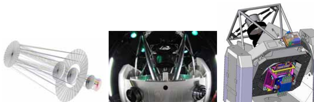
圖一：(a) Pan-STARRS 望遠鏡光路圖，最大的元件代表 1.8 公尺口徑之主鏡，反射光線到左方次鏡，之後經過三個修正鏡。最右方的紅色圓盤代表望遠鏡之卡賽格蘭焦點平面。(b) 望遠鏡照片，可以看到次鏡與修正鏡。(c) 望遠鏡卡賽格蘭焦點儀器配掛示意圖。
