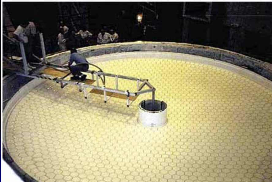
玻璃融化、旋轉、冷卻後大致成爲拋物面，然後予以精密研磨，最後表面鍍上高反光薄膜
