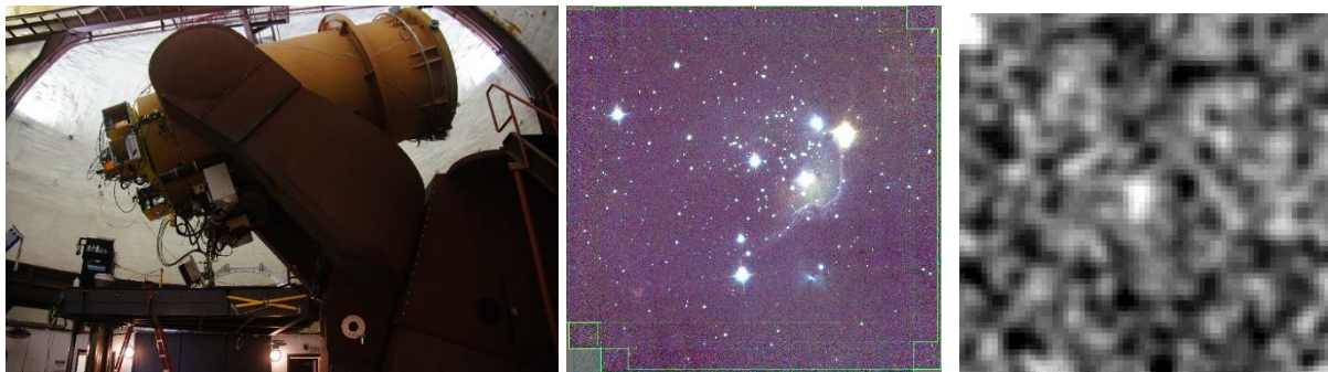
(左) NCUIRCam 配置在 UH88 望遠鏡後方；(中) 安裝初期所拍攝的恆星形成區測試影像，經過後製三色合成；(右) 依據泛星計畫的數據所選取的高紅移類星體候選天體，經由 UH88/NCUIRCam 所拍攝的 J 波段近紅外影像，能推論極為可能是距離極其遙遠類星體，亮度 J=21.9 AB 有待進一步申請大型望遠鏡進行光譜驗證。視野為 10 \times 10 角秒，曝光總時間 1.8 小時 (by Koptelova)。
