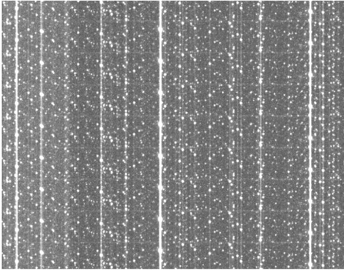
圖 5：拉鍊模式影像。藉由不斷的停留-位移-讀出程序，快速讀取影像資料。由於在過程中，快門都是開啟的，因此星體產生了如拉鍊般、由亮紋連接的成串亮點，所以稱此影像為拉鍊模式影像。這也造成在天空中位置相近的恆星同時、從不同方位被偵測造成重疊影像。
