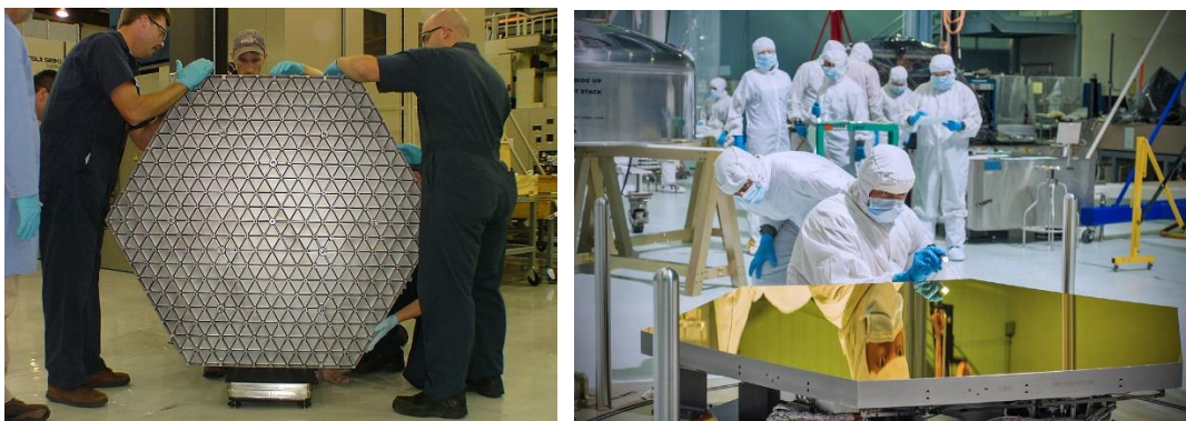
(左) 韋伯望遠鏡由鈹元素製作的鏡胚，(右) 之外以黃金鍍膜，有利反射紅外波
